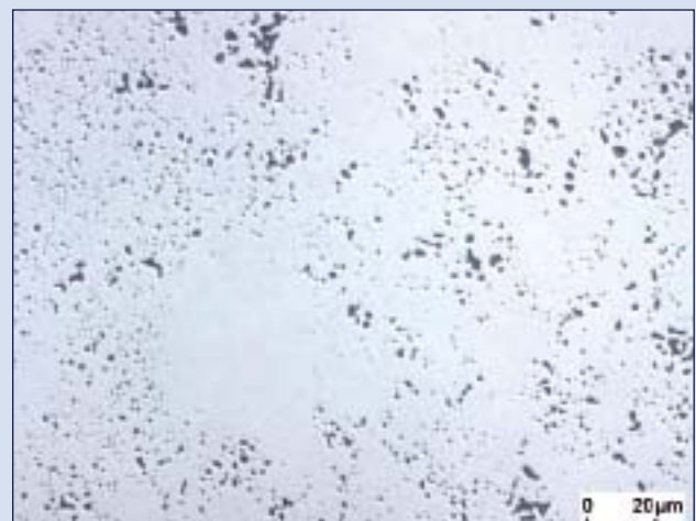
4 MasterTec-1 im Ofen gesintert bei 1000^\circ\text{C} / 1,5 \text{ t/cm}^2 / 60 Minuten / Formiergas
