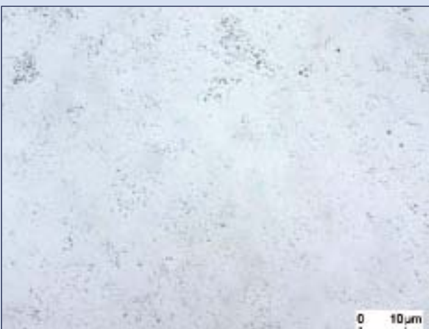
3 MasterTec-1 heißgepresst bei 700^\circ\text{C} / 3 Minuten / 350 \text{ kg/cm}^2
