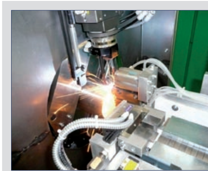
Das Laserschweißen von Bohrkronen mit der BSM 300 der Dr. Fritsch GmbH.
