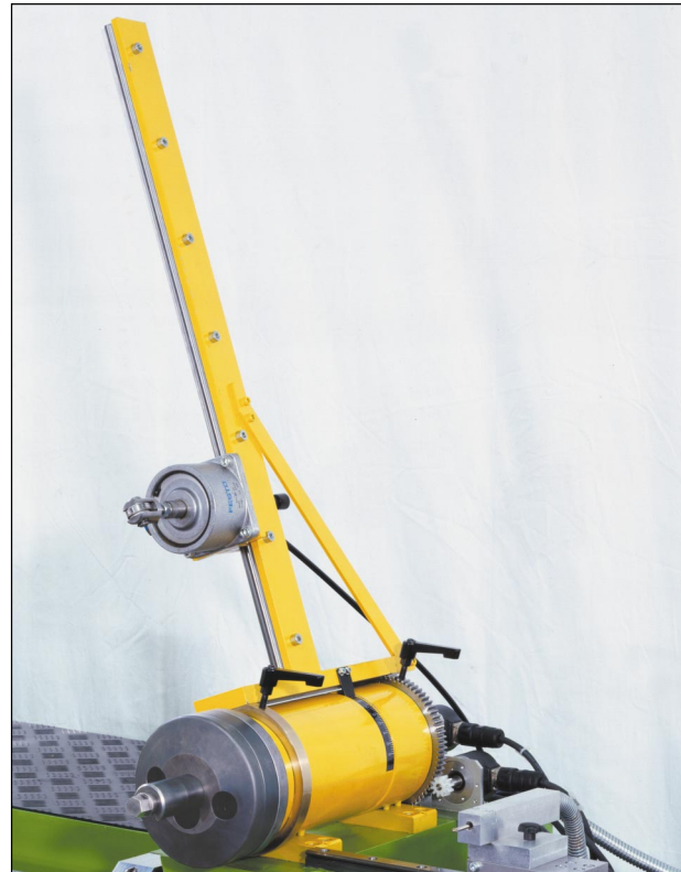
3 Die Spannungsprüfung auf der SWP 116 erfolgt nach der Winkelmethode
