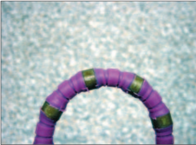
2 Sägeseil unter starker Verbiegung
