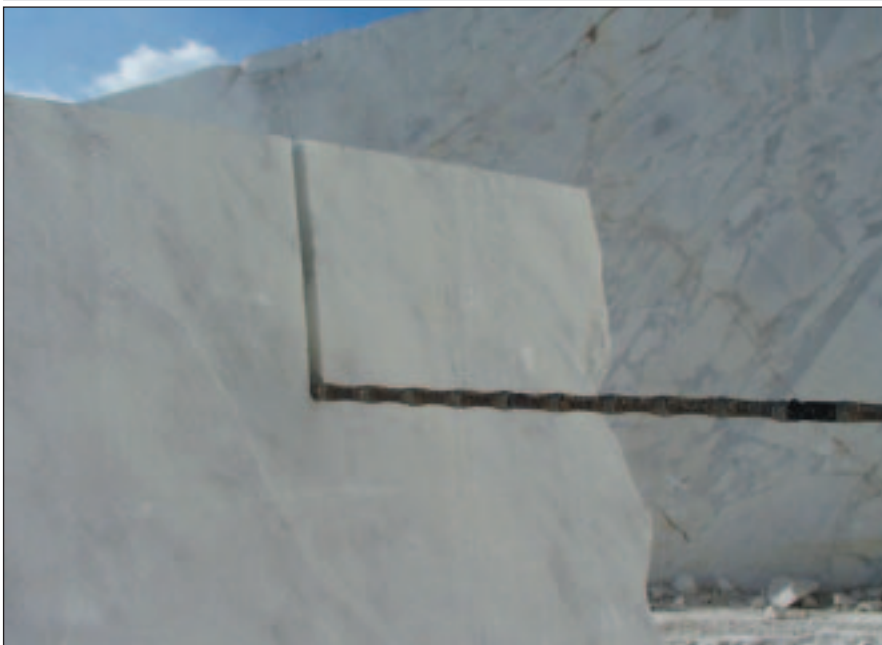
1 Sägeseil bei der Marmorbearbeitung
